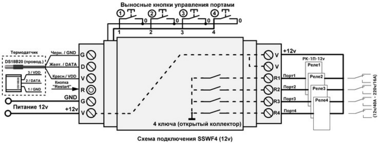
Вариант 1. Питание от внешнего источника питания 12v и 4-мя встроенными ключами открытой коллектор
